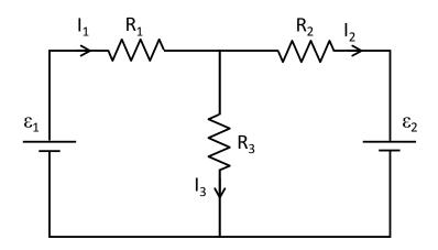
a.  $\mathcal{E}_1 - \mathcal{E}_2 - I_1 R_1 - I_2 R_2 = 0$ b.  $\mathcal{E}_1 - I_1 R_1 - I_3 R_3 = 0$ c.  $\mathcal{E}_2 - I_2 R_2 - I_3 R_3 = 0$
