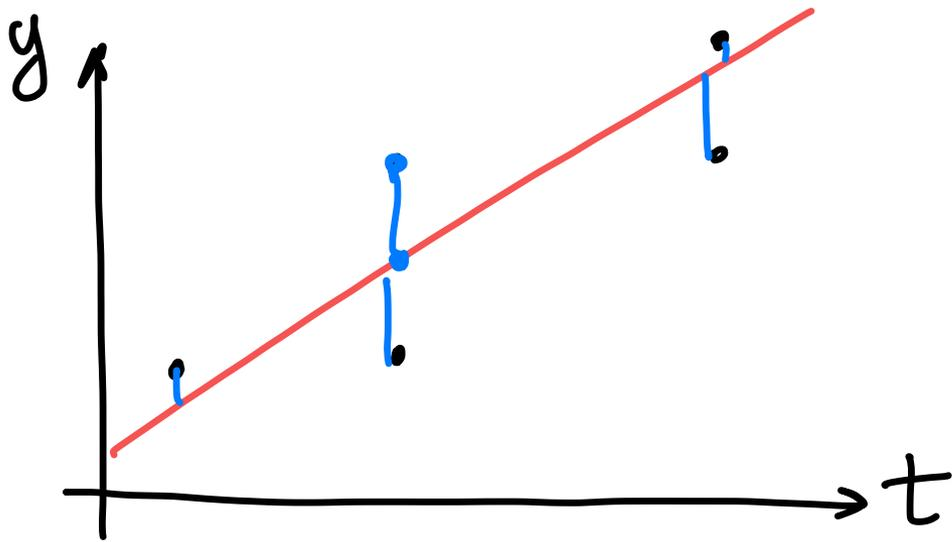
$$\begin{bmatrix} 1 & t_1 \\ 1 & t_2 \\ \vdots & \vdots \\ 1 & t_m \end{bmatrix} \begin{bmatrix} x_0 \\ x_1 \\ \vdots \\ x_{n-1} \end{bmatrix} = \begin{bmatrix} y_1 \\ y_2 \\ \vdots \\ y_m \end{bmatrix}$$
