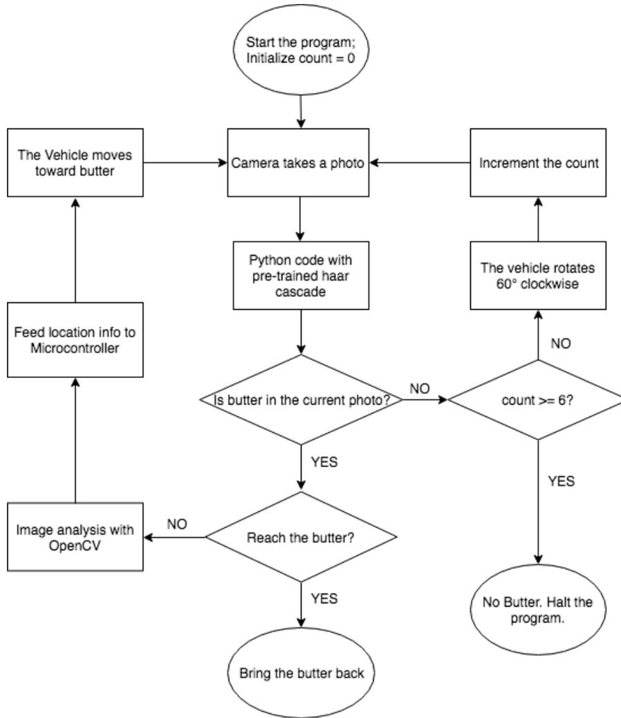
Fig. 4. Control Module Flowchart
