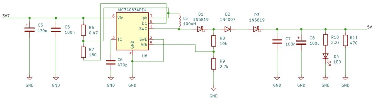
Figure 2.3.1.2 Voltage Boost Converter
