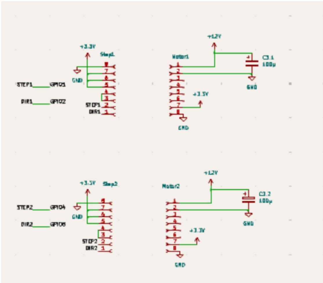
Figure 9. Motor Subsystem
