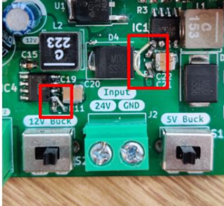
Fig C.2.2: Enable Pin Bodge Wiring
