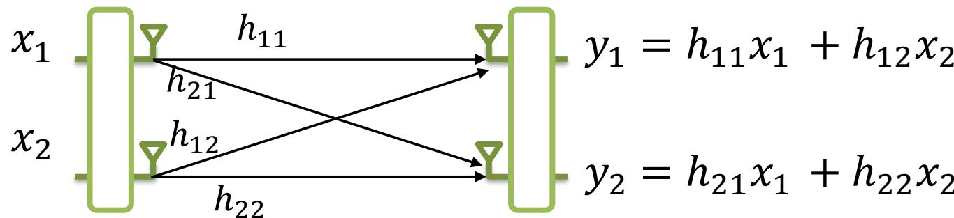
$$\begin{bmatrix} y_1 \\ y_2 \end{bmatrix} = \begin{bmatrix} h_{11} & h_{12} \\ h_{21} & h_{22} \end{bmatrix} \begin{bmatrix} x_1 \\ x_2 \end{bmatrix} + \begin{bmatrix} n_1 \\ n_2 \end{bmatrix} \quad \rightarrow \quad \mathbf{y} = \mathbf{H}\mathbf{x} + \mathbf{n}$$
