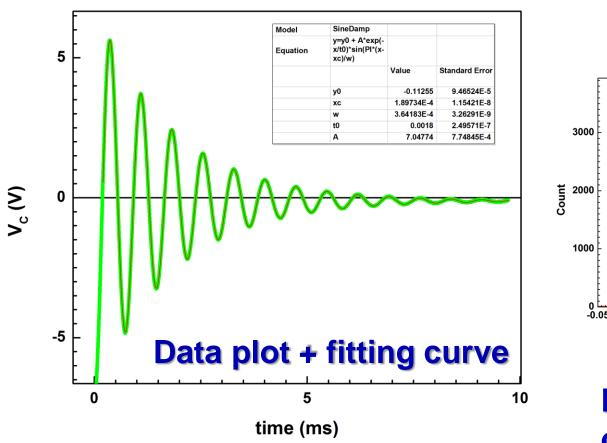
$q(t) = Ae^{-at}sin(\omega t + \varphi)$
