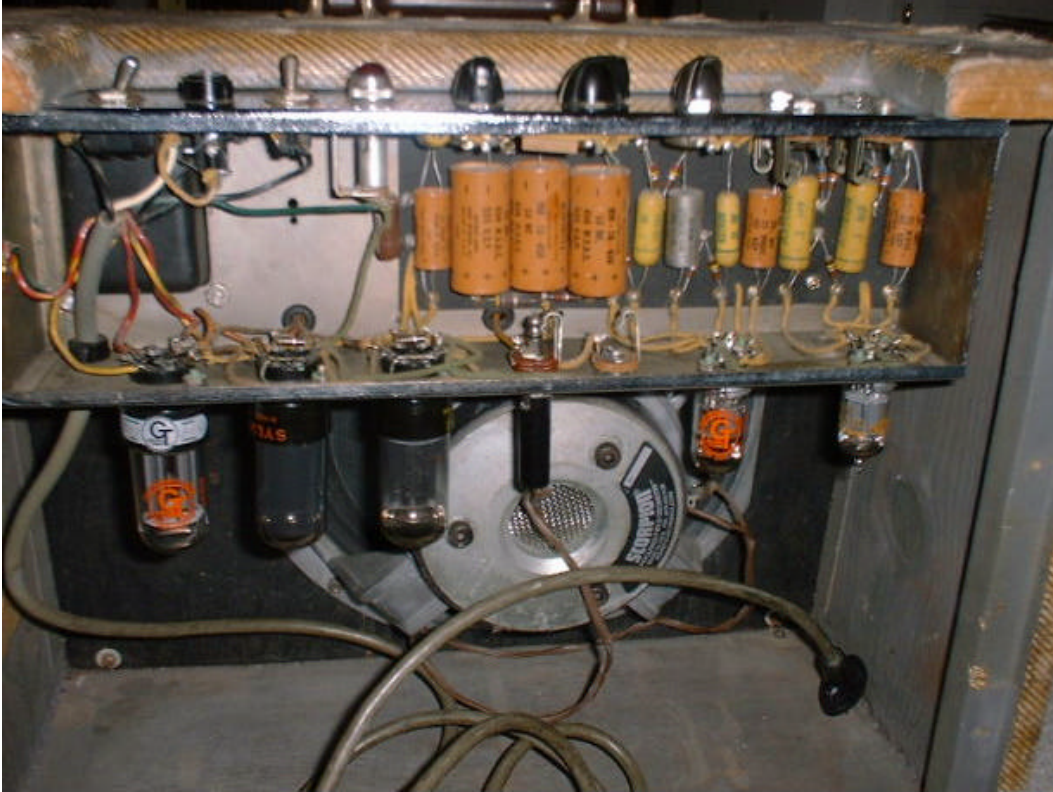
Figure 3. Actual Fender Tweed Deluxe circuit layout.
