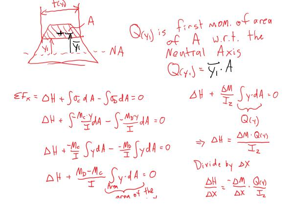
$$T_{xy} = \frac{V_{(x)} \cdot \hat{Q}_{(y)}}{I_z \cdot t_{(y)}}$$
